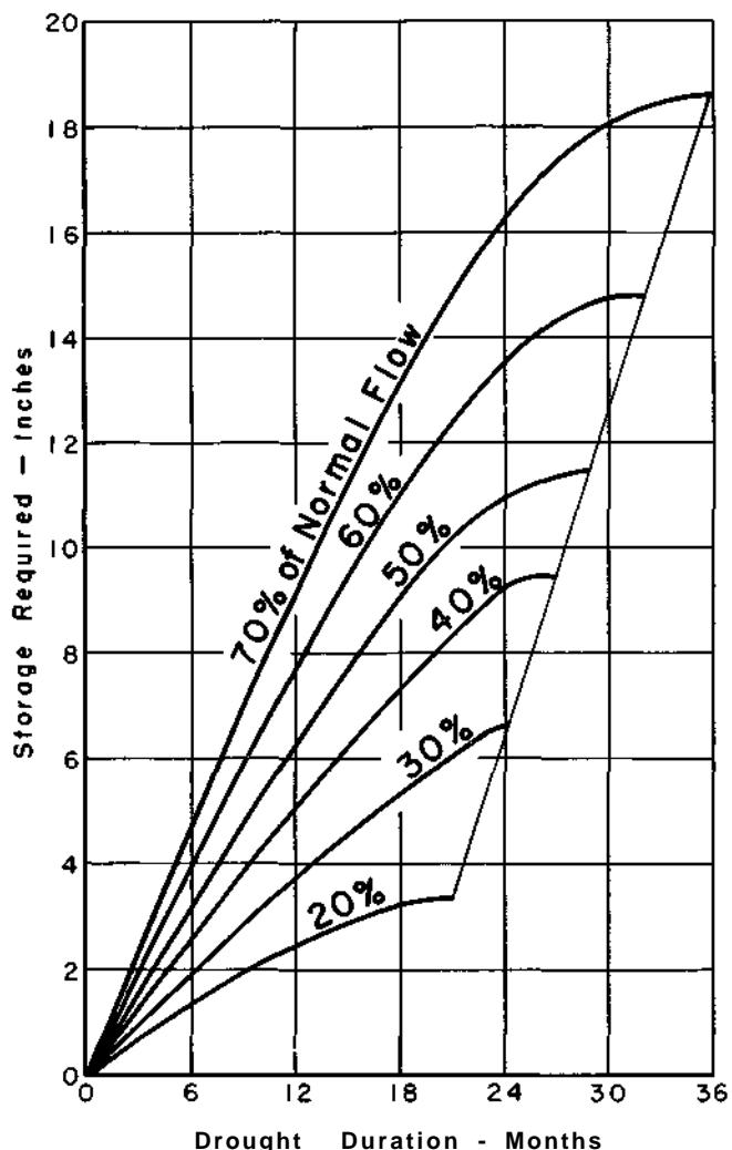
FIGURE 3 RUNOFF REQUIRED FOR STORAGE USE DURING DROUGHT
